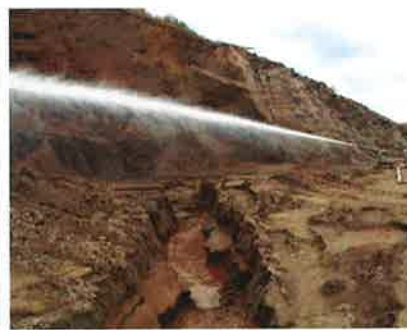
Rys. 2. Przykładowy schemat testu stanowiskowego hydro-urabiania kaliny węglowej w warunkach Kopalni Doświadczalnej „Barbara” oraz przykład „działka wodnego” i test zasięgu strugi wody (hydro-urabianie).
