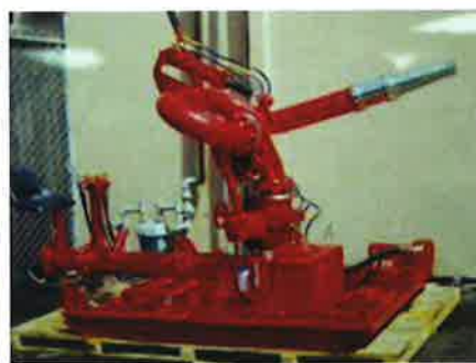
Rys. 2. Przykładowy schemat testu stanowiskowego hydro-urabiania kaliny węglowej w warunkach Kopalni Doświadczalnej „Barbara” oraz przykład „działka wodnego” i test zasięgu strugi wody (hydro-urabianie).
